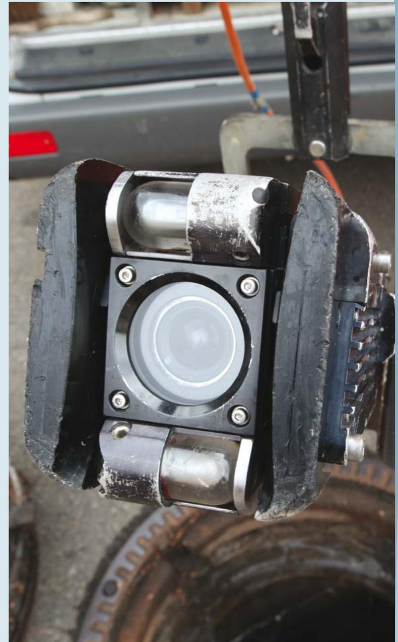
Spezialkamera zur Verfilmung der Kanäle im Saarbrücker Untergrund
