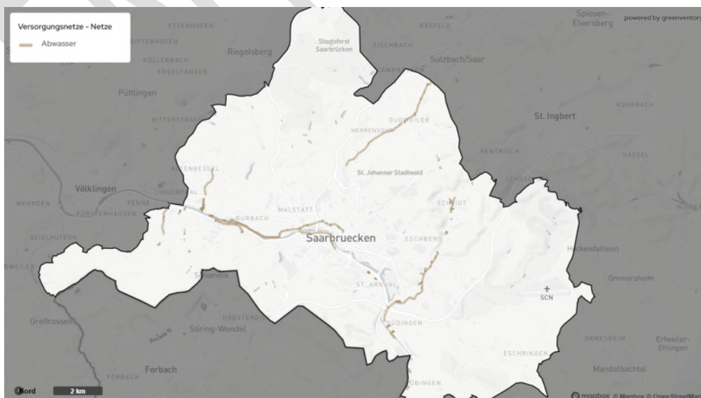
Abbildung 23: Bestehende Abwassernetze (Mindestnennweite DN 800) in Saarbrücken
